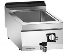
Bain-marie mit selbsttragender Konstruktion aus CNS nach DIN 1.4301, Stärke des Oberteils 2 mm. Tiefgezogenes wasserdichtes Becken im Oberfläche integriert, mit satiniertes Feinbearbeitung. Für GN-Behälter 1/1 oder Teiler. Indirekte Beheizung durch Arbeitsthermostat 30-90°C und Sicherheitsthermostat. Mit Behälter zu ergänzen. Vorrüstung für die Fernüberwachung der Leistungsspitzen.
