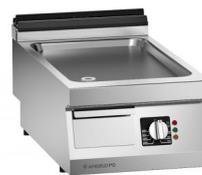
Modell verfügbar nur in Länder außerhalb vor Europäischen Gemeinschaft. Bratplatte mit Ummantelung aus CNS nach DIN 1.4301. Stärke des Oberteils 2 mm. Platte aus Stahl nach DIN Fe510D, feingeschleiffen. EVEN- PRO-SYSTEM. Geliefert mit Platte-Pfropfen. Beheizung durch Heizkörper aus CNS nach DIN 1.4828, Sicherheitsthermostat. Betriebstemperatur (Min-max): 70-260°C.
