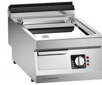
Bratplatte mit Ummantelung aus CNS nach DIN 1.4301. Stärke des Oberteils 2 mm. Platte aus Stahl nach DIN Fe510D hartverchromt. EVEN-PRO-SYSTEM. Geliefert mit Platte-Pfropfen. Beheizung durch Heizkörper aus CNS nach DIN 1.4828, Sicherheitsthermostat. Betriebstemperatur (Min-max): 70-260°C.
