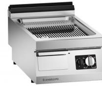
Bratplatte mit Ummantelung aus CNS nach DIN 1.4301. Stärke des Oberteils 2 mm. Platte aus Stahl nach DIN Fe510D hartverchromt. Geliefert mit Platte-Pfropfen. Beheizung durch Brennerbatterie, Steuerung mit modulierendem Thermostatventil, Sicherheitsthermostat. Betriebstemperatur (Min-max): 100-280°C.
