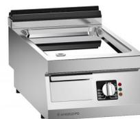
Bratplatte mit Ummantelung aus CNS nach DIN 1.4301. Stärke des Oberteils 2 mm. Platte aus Compound (CNS nach DIN 1.4404+FE). EVEN-PRO-SYSTEM. Geliefert mit Platte-Pfropfen. Beheizung durch Heizkörper aus CNS nach DIN 1.4828, Sicherheitsthermostat. Betriebstemperatur (Min-max): 70-260°C.
