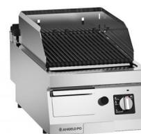
Grill mit Ummantelung aus CNS nach DIN 1.4301. Stärke des Oberteils 2 mm. Grill mit Kochrost aus schwarz-emailliertem Gusseisen mit oberer nanotechnologischerer Behandlung um Fettsgleiten zu verbessern, komplett mit Spritzschutzblechen und Schaber. Heizung durch Brenner mit Thermoelement-Kontrollleuchte und piezoelektrischer Zündung. Das Kochen erfolgt durch Bestrahlung der vom Brenner erhitzten Keramikelemente.
