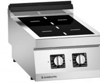
Glaskeramikherd mit selbsttragender Konstruktion aus CNS nach DIN 1.4301, Stärke des Oberteils 2 mm. Arbeitsplatte mit Glaskeramik, bündig und flüssigkeitsdicht zusammengefügt. Beheizung durch Induktion. 2 unabhängige Kochstelle. Topferkennungssensoren und automatische Kontrollvorrichtungen. Beanspruchte Kühlung der elektronischen Bauelemente. Es ist notwendig Kochtöpfe (Ø 120 mm minimum) aus geeignetem Material zu verwenden.
