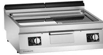
Bratplatte mit Ummantelung aus CNS nach DIN 1.4301. Stärke des Oberteils 2 mm. Platte aus Stahl nach DIN Fe510D hartverchromt. Geliefert mit Platte-Pfropfen. Beheizung durch zwei unabhängigen Brennerbatterien, Steuerung mit modulierendem Thermostatventil, Sicherheitsthermostat. Betriebstemperatur (Min-max): 100-280°C.
