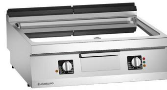
Bratplatte mit Ummantelung aus CNS nach DIN 1.4301. Stärke des Oberteils 2 mm. Platte aus Compound (CNS nach DIN 1.4404+FE). EVEN-PRO-SYSTEM. Geliefert mit Platte-Pfropfen. Beheizung durch zwei unabhängigen Heizkörperbatterien aus CNS nach DIN 1.4828 unter der Platte, Sicherheitsthermostat. Betriebstemperatur (Min-max): 70-260°C.
