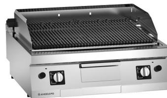
Grill mit Ummantelung aus CNS nach DIN 1.4301. Stärke des Oberteils 2 mm. Grill mit Kochrost aus schwarz-emailliertem Gusseisen mit oberer nanotechnologischerer Behandlung um Fettsgleiten zu verbessern, komplett mit Spritzschutzblechen und Schaber. Heizung durch 2 unabhängigen Brennern mit Thermoelement-Kontrollleuchte und piezoelektrischer Zündung. Das Kochen erfolgt durch Bestrahlung der vom Brenner erhitzten Keramikelemente.
