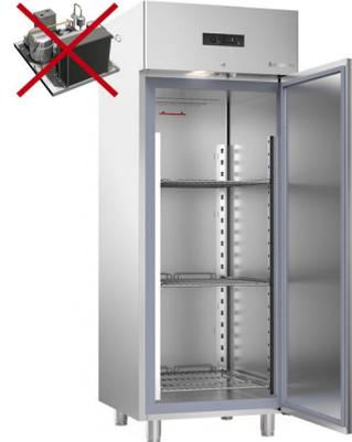
Kühlschrank mit innerer und äußerer Monoblockstruktur aus C.N.S. nach DIN1.4301. Innerer Kühlraum mit Rosttrageleisten aus C.N.S. nach DIN 1.4301, mit 21 Niveaus. Umluftkühlsystem, Verdampfer außerhalb des Kühlraums. Schalttafel mit digitalem Thermometer-Thermostat. Elektrische Luftabtauung. Ausstattung je Fach: n. 3 Führungsschienen aus C.N.S. nach DIN 1.4301 und n. 3 rilsanierte Roste.
