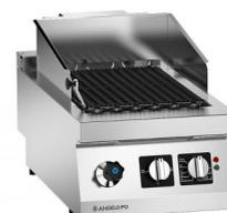
Parrilla construída en acero inox AISI 304, espesor plano 20/10 mm. Rejilla de cocción en fundición esmaltada con tratamiento superficial nanotecnológico que favorece el escurrido de la grasas, equipada de protección anti salpicadura en acero inox y cepillo. Calentamiento por medio de una batería de resistencias volcables. Cuba debajo plano, llenado por grifo con mando de ajuste, capacidad 5,2 lt (rebosadero).
