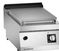
Cocina de todoplancha construída en acero inox AISI304, espesor plano 20/10 mm. Placa radiante realizada de acero 16 Mo5. Calentamiento placa por quemador central de acero inox accionado por grifo valvulado, con espia piloto y termopar. Encendido piezoeléctrico.
