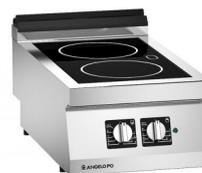
Cocina con plano en vitrocerámica, estructura autoportante de acero inox AISI304, espesor plano 20/10 mm. Encimera con vidrioceramica, insertada a ras en la encimera y estanca a los líquidos. Calentamiento por resistencias infrarrojo. 2 áreas de cocción independientes controladas por regulador de energia.
