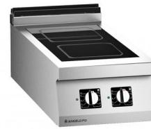
Cocina con plano en vitrocerámica, estructura autoportante de acero inox AISI304, espesor plano 30/10 mm. Encimera con vidrioceramica, insertada a ras en la encimera y estanca a los líquidos. Calentamiento por inducción. Zona total, con 2 áreas de cocción independiente. Sensores reconocimiento olla y dispositivos automáticos de control. Refrigeración forzada de los componentes electrónicos. Utilizar recipientes de cocción del material idóneo (Ø mínimo 120 mm).
