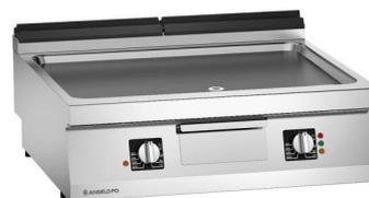
Disponibile sólo para los países fuera de la Comunidad Europea. Fry-top construido en acero inox AISI 304, espesor plano 20/10 mm. Plancha de cocción de acero Fe510D satinado. SISTEMA EVEN-PRO. En dotación: tapón placa. Calentamiento por dos baterías de resistencias electricas de acero inox AISI 309 dabajo placa, termostato de seguridad. Temperatura de trabajo (min-max): 70-260°C.
