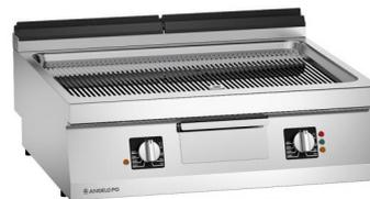
Fry-top construido en acero inox AISI 304, espesor plano 20/10 mm. Plancha de cocción de acero Fe510D tratada al cromo duro. SISTEMA EVEN-PRO. En dotación: tapón placa. Calentamiento por dos baterías de resistencias electricas de acero inox AISI 309 dabajo placa, termostato de seguridad. Temperatura de trabajo (min-max): 70-260°C.
