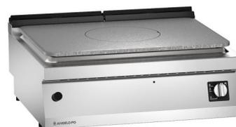
Cocina de todoplancha construída en acero inox AISI304, espesor plano 20/10 mm. Placa radiante realizada de acero 16 Mo5. Calentamiento placa por quemador central de acero inox accionado por grifo valvulado, con espia piloto y termopar. Encendido piezoeléctrico.
