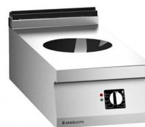
Elément avec dessus en vitro-céramique avec structure autoportante en acier inox AISI 304, dessus épaisseur 20/10 mm. Elément de cuisson avec wok Ø 300 mm en vitrocéramique. Chauffe par induction. Capteur de reconnaissance des marmites et dispositif automatique de sécurité. Système de refroidissement des composants électroniques. Utiliser des récipients convenables.
