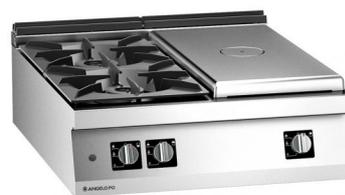
Fourneau gaz réalisé en acier inox AISI 304, dessus épaisseur 20/10 mm. Grilles feux vifs et brûleurs en fonte émaillée. Brûleurs amovibles avec tête de double couronne contrôlés par robinet gaz de sécurité. Veilleuse pilote et thermocouple. Cuvette sous brûleurs emboutie et étanche. Demie plaque radiante sur le plan de travail à droite.
