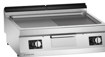
Disponibile solo per i paesi al di fuori della Comunità Europea. Fry-top realizzato in acciaio inox AISI 304, spessore piano di lavoro 20/10 mm. Piastra di cottura in acciaio Fe510D satinato. In dotazione: tappo piastra. Riscaldamento tramite due batterie di bruciatori indipendenti comandati da valvola termostatica ad azione modulante. Temperatura di lavoro (min-max): 130-320°C.
