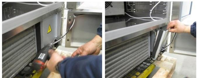
Verriegelungsschrauben des Schaltkastens entfernen.
