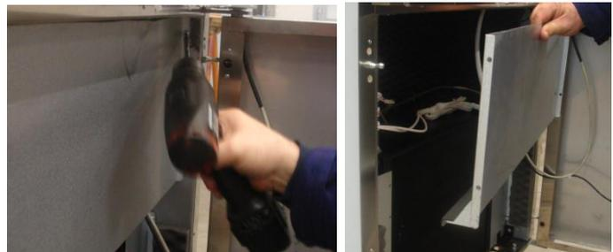
Verriegelungsschrauben des Schaltkastens entfernen.
