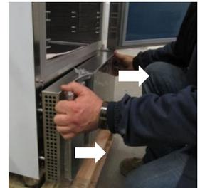
Schrauben des Verschlusspaneels entfernen.
