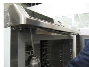
Desserrer les vis et retirer le couvercle pour accéder à la carte vidéo et le encodeur
