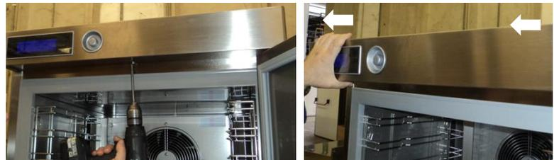
Desserrer les vis de la protection et la retirer le couvercle pour accéder la carte vidéo et le encodeur.
