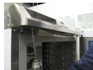
Ослабьте винты и снимите крышку для доступа к видеокарте и датчик
