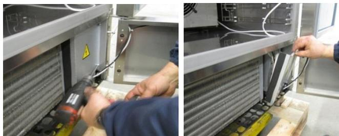
Удалить фиксирующие винты электрического щита.
