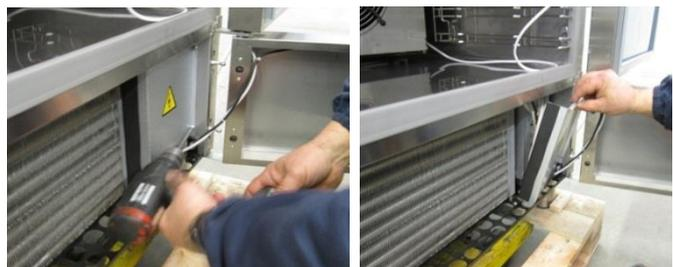
Verriegelungsschrauben des Schaltkastens entfernen.
