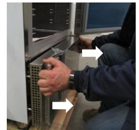
Schrauben des Verschlusspaneels entfernen.
