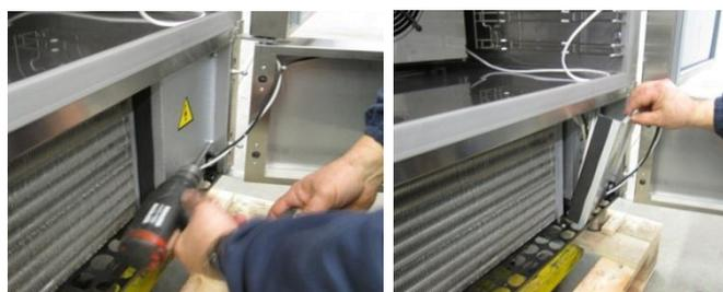
Retirer les vis de blocage du tableau électrique.
