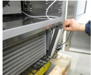
Remover o parafuso de bloqueio do quadro eléctrico.
