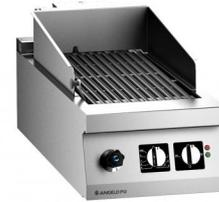
Elektro-Grill mit Ummantelung aus CNS nach DIN 1.4301, Stärke des Oberteils 2 mm. Kochrost aus schwarz-emailliertem Gusseisen mit oberer nanotechnologischerer Behandlung, mit Spritzschutzblechen und Schaber geliefert. Heizung durch klappbare Heizkörperbatterien. Unterbecken mit Wasserfüllung durch Hahn mit Einstellknopf, Beckenfassungsvermögen 10 Lt (Überlauf). Vorbereitung für Fernüberwachung der Leistungsspitzen.
