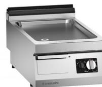
Modell verfügbar nur in Länder außerhalb vor Europäischen Gemeinschaft. Bratplatte mit Ummantelung aus CNS nach DIN 1.4301. Stärke des Oberteils 2 mm. Platte aus Stahl nach DIN Fe510D, feingeschleiffen. Geliefert mit Platte-Pfropfen. Beheizung durch Brennerbatterie, Steuerung mit modulierendem Thermostatventil. Betriebstemperatur (Min-max): 130-320°C.
