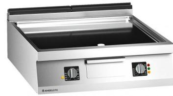
Bratplatte mit Ummantelung aus CNS nach DIN 1.4301. Stärke des Oberteils 2 mm. Platte aus Stahl nach DIN Fe510D hartverchromt. COOKING PRO-SYSTEM. Geliefert mit Platte-Pfropfen. Beheizung durch zwei unabhängigen Heizkörperbatterien aus CNS nach DIN 1.4828 unter der Platte, Sicherheitsthermostat. Betriebstemperatur (Min-max): 70-260°C. Vorbereitung für Fernüberwachung der Leistungsspitzen.
