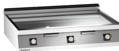
Bratplatte mit Ummantelung aus CNS nach DIN 1.4301. Stärke des Oberteils 2 mm. Platte aus Compound (CNS nach DIN 1.4404+FE). COOKING PRO-SYSTEM. Geliefert mit Platte-Pfropfen. Beheizung durch drei unabhängigen Heizkörperbatterien aus CNS nach DIN 1.4828, Sicherheitsthermostat. Betriebstemperatur (Min-max): 70-260°C. Vorbereitung für Fernüberwachung der Leistungsspitzen.
