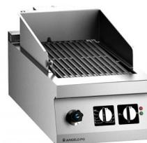
Parrilla electrica con estructura de acero inox AISI 304, espesor plano 20/10 mm. Rejilla de cocción en fundición esmaltada con tratamiento superficial nanotecnológico, suministrada con anti salpicadura en acero inox y cepillo. Calentamiento por medio de una batería de resistencias volcables. Cuba debajo plano, llenado por grifo con mando de ajuste, capacidad 10 lt (rebosadero). Predisposición para el control a distancia de los picos de potencia.
