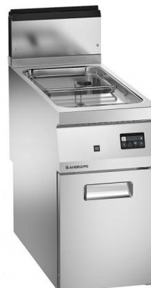
Freidora construída en acero inox AISI304, espesor plano 20/10 mm. Cubas estampadas y soldadas al plano, anchas zonas de escurrido y decantación aceite; en dotación cada cuba: 1 cesto y 1 tapa. Mandos digitales. Tarjeta electrónica para el control y visualización de la temperatura 0-190°C, programa de "derretido" y mantenimiento a 90°C, alarma sonora de fin de cocción. Quemadores tubulares en la cuba. Encendido eléctrico por tren de chispas, termostato de seguridad.
