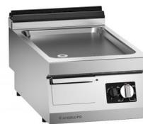
Disponible sólo para los países fuera de la Comunidad Europea. Fry-top construido en acero inox AISI 304, espesor plano 20/10 mm. Plancha de cocción de acero Fe510D satinado. En dotación: tapón placa. Calentamiento por batería de quemadores comandada por válvula termostática de acción modulante. Temperatura de trabajo (min-max): 130-320°C.
