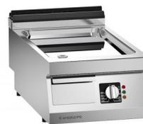
Fry-top construido en acero inox AISI 304, espesor plano 20/10 mm. Plancha de cocción de acero Fe510D tratada al cromo duro. SISTEMA EVEN-PRO. En dotación: tapón placa. Calentamiento por resistencias electricas de acero inox AISI 309, termostato de seguridad. Temperatura de trabajo (min-max): 70-260°C.
