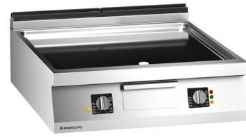
Fry-top construido en acero inox AISI 304, espesor plano 20/10 mm. Plancha de cocción de acero Fe510D tratada al cromo duro. SISTEMA COOKING PRO. En dotación: tapón placa. Calentamiento por dos baterías de resistencias electricas de acero inox AISI 309 dabajo placa, termostato de seguridad. Temperatura de trabajo (min-max): 70-260°C. Predisposición para el control a distancia de los picos de potencia.
