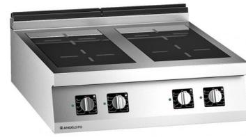
Cocina con plano en vitrocerámica, estructura autoportante de acero inox AISI304, espesor plano 20/10 mm. Encimera con vitrocerámica, insertada a ras en la encimera y estanca a los líquidos. Calentamiento por inducción. 4 áreas de cocción independiente. Sensores reconocimiento olla y dispositivos automáticos de control. Refrigeración forzada de los componentes electrónicos. Utilizar recipientes de cocción del material idóneo (Ø mínimo 120 mm).
