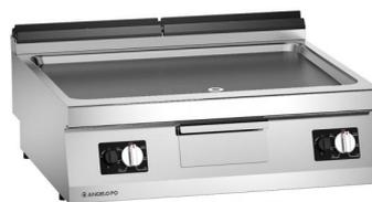
Disponibile sólo para los países fuera de la Comunidad Europea. Fry-top construido en acero inox AISI 304, espesor plano 20/10 mm. Plancha de cocción de acero Fe510D satinado. En dotación: tapón placa.
