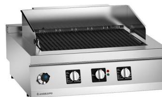
Parrilla construída en acero inox AISI 304, espesor plano 20/10 mm. Rejilla de cocción en fundición esmaltada con tratamiento superficial nanotecnológico que favorece el escurrido de la grasas, equipada de protección anti salpicadura en acero inox y cepillo. Calentamiento por medio de dos baterías independientes de resistencias volcables. Cuba debajo plano, llenado por grifo con mando de ajuste, capacidad 13 lt (rebosadero).
