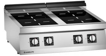
Cocina con plano en vitrocerámica, estructura autoportante de acero inox AISI304, espesor plano 20/10 mm. Encimera con vitrocerámica, insertada a ras en la encimera y estanca a los líquidos. Calentamiento por inducción. 4 áreas de cocción independiente. Sensores reconocimiento olla y dispositivos automáticos de control. Refrigeración forzada de los componentes electrónicos. Utilizar recipientes de cocción del material idóneo ( $\varnothing$  mínimo 120 mm).
