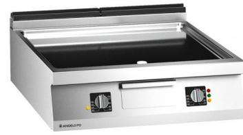
Fry-top construido en acero inox AISI 304, espesor plano 30/10 mm. Plancha de cocción de compound (acero inox AISI 316L+FE). SISTEMA COOKING PRO. En dotación: tapón placa. Calentamiento por dos baterías de resistencias electricas de acero inox AISI 309 dabajo placa, termostato de seguridad. Temperatura de trabajo (min-max): 70-260°C. Predisposición para el control a distancia de los picos de potencia.
