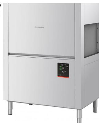
Lavavajillas de arrastre fabricado en acero inoxidable AISI 304 con paredes laterales de doble pared espaciada. Puertas de doble pared. Cubas de acero inoxidable totalmente moldeadas. Filtros integrales de acero inoxidable en la cuba. Fases de lavado: lavado - aclarado. 2 velocidades de avance cestos. Dirección de avance del cesto: de derecha a izquierda.
