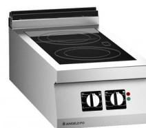
Elément avec dessus en vitro-céramique avec structure autoportante en acier inox AISI 304, dessus épaisseur 20/10 mm. Elément de cuisson en vitrocéramique, intégrée à fleur du plan de travail de façon étanche. Chauffe par résistances à infrarouge. 2 zones de cuisson indépendantes contrôlées par régulateur d'énergie. Pré-équipement pour raccordement à un optimiseur d'énergie.
