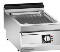
Disponible uniquement pour les pays hors Communauté Européenne. Élément grillade réalisé en acier inox AISI 304, dessus épaisseur 20/10 mm. Plaque de cuisson en acier Fe510D satiné. SYSTEME EVEN-PRO. En dotation: bouchon plaque. Chauffe par résistances électriques en acier inox AISI 309, thermostat sécurité. Température de travail (min-max): 70-260°C.
