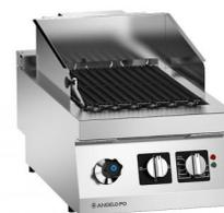
Élément grillade réalisé en acier inox AISI 304, dessus épaisseur 20/10 mm. Grillade barréaudée avec grille de cuisson en fonte émaillée avec traitement nanotechnologique améliorant le glissement des graisses, en dotation des pare-éclaboussures en inox et une raclette de nettoyage. Chauffe par un groupe de batteries de résistances basculantes. Cuve au-dessous, remplissage par robinet avec poignée de réglage, capacité 5,2 lt (trop-plein).
