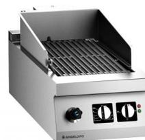
Grillade barréaudée électrique, avec structure réalisée en acier inox AISI 304, dessus épaisseur 30/10 mm. Grille de cuisson en fonte émaillée avec traitement nanotechnologique, équipée de pare-éclaboussures et raclette de nettoyage. Chauffe par un groupe de batteries de résistances basculantes. Cuve au-dessous, remplissage par robinet avec poignée de réglage, capacité 10 lt (trop-plein). Pré-équipement pour raccordement à un optimiseur d'énergie.
