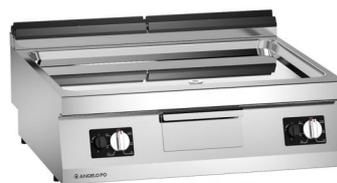
Élément grillade réalisé en acier inox AISI 304, dessus épaisseur 20/10 mm. Plaque de cuisson en acier Fe510D traitée au chrome dur. En dotation: bouchon plaque. Chauffe par rampe deux rampes indépendantes de brûleurs contrôlée par robinet thermostatique à action modulante, thermostat sécurité. Température de travail (min-max): 100-280°C.
