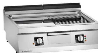
Élément grillade réalisé en acier inox AISI 304, dessus épaisseur 20/10 mm. Plaque de cuisson en acier Fe510D traitée au chrome dur. SYSTEME EVEN-PRO. En dotation: bouchon plaque. Chauffe par deux rampes de résistances électriques en acier inox AISI 309 sous plaque, thermostat sécurité. Température de travail (min-max): 70-260°C.
