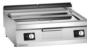
Élément grillade réalisé en acier inox AISI 304, dessus épaisseur 20/10 mm. Plaque de cuisson en bimétal (acier inox AISI316L+FE). En dotation: bouchon plaque. Chauffe par rampe deux rampes indépendantes de brûleurs contrôlée par robinet thermostatique à action modulante. Température de travail (min-max): 130-320°C.
