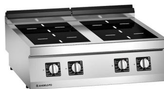
Elément avec dessus en vitro-céramique avec structure autoportante en acier inox AISI 304, dessus épaisseur 20/10 mm. Elément de cuisson en vitrocéramique, intégrée à fleur du plan de travail scellé de façon étanche. Chauffe par induction. 4 zones de cuisson indépendantes. Capteurs de reconnaissance des marmites et dispositif automatique de sécurité. Système de refroidissement des composants électroniques. Utiliser des récipients convenables ( $\varnothing$  120 mm minimum).
